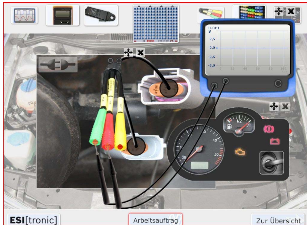
Abbildung 4: Signalmessung am Drehzahlgeber mit dem Oszilloskop
